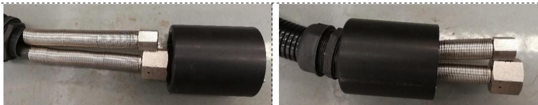
两根软管正确穿入位置
