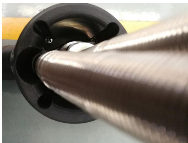
胶管护套装回到加氢枪主体
