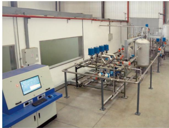
■ 两相流流量标准装置 Two-phase flowmeter Calibration Device 使用高压氮气和水作为介质，利用气液混合器将气液混合均匀，对两相流量计进行精度测试和稳定性测试。
