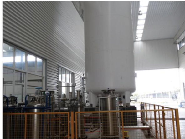
■ 低温液体流量标准检定装置 Cryogenic liquid flow calibration device 使用零下196℃液氮低温介质对低温流量计进行精度测试和稳定性测试
