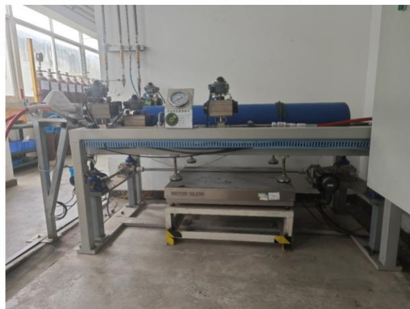
■ 低温液体流量标准检定装置 Cryogenic liquid flow calibration device 使用零下196℃液氮低温介质对低温流量计进行精度测试和稳定性测试
