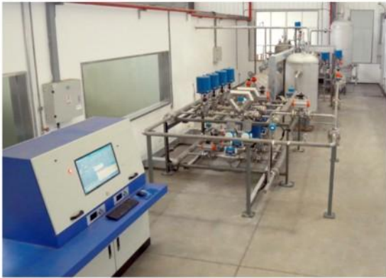
两相流流量标准装置 Two-phase flowmeter Calibration Device 使用高压氮气和作为介质，利用气液混合器将气液混合均匀，对两相流流量计进行精度测试和稳定性测试
